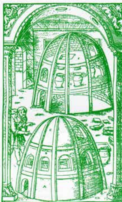
Forno per la produzione del vetro (G. Agricola, "De Re Metallica", 1556)
